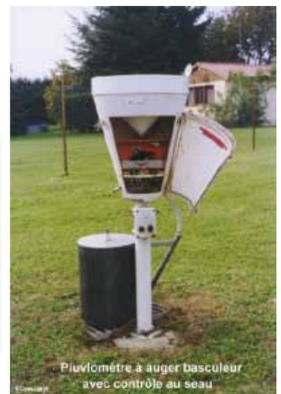
Pluviomètre à auger basculeur avec contrôle au seuil
